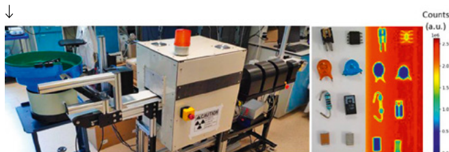
↓ Figure 2 : Démonstrateur [10 kg/h ou 72 000 composants/h] de tri de composants électroniques permettant de les séparer sur la base de leur composition chimique élémentaire. Cet outil permet de réduire la complexité d'un mélange de déchets électroniques de 60 éléments chimiques à seulement quelques-uns [entre 4 à 6 en moyenne]. Cette simplification permet de rendre économiquement viable les procédés de recyclage de « métaux orphelins » [non recyclés].
