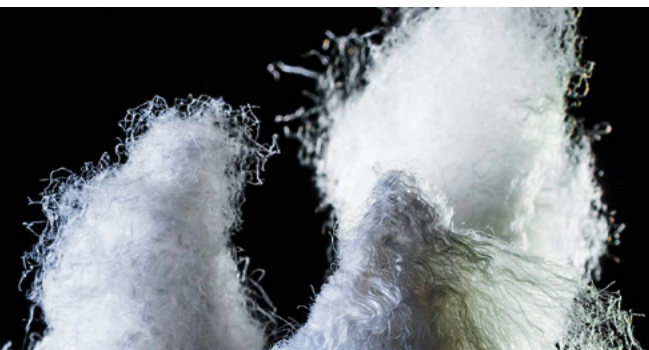
↑ Figure 4 : Nanofibres NFA - Acide polyacrylique. Brevets CEA. Sélectivité métaux lourds bivalents.
