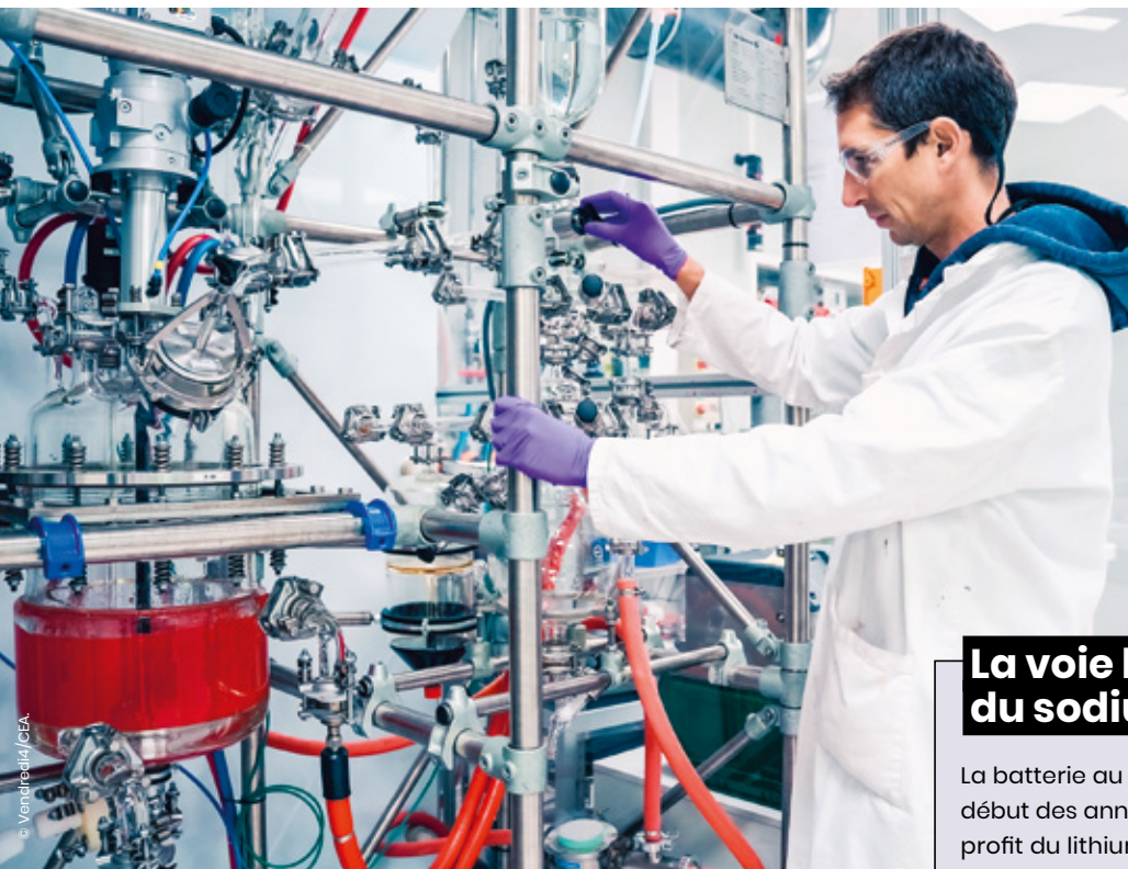
← Réacteur de laboratoire (à gauche) pour la synthèse à grande échelle de matériaux de batterie, sous atmosphère contrôlée.
