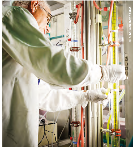
Expérience d'extraction sélective en colonne pulsée au CEA de Marcoule.
