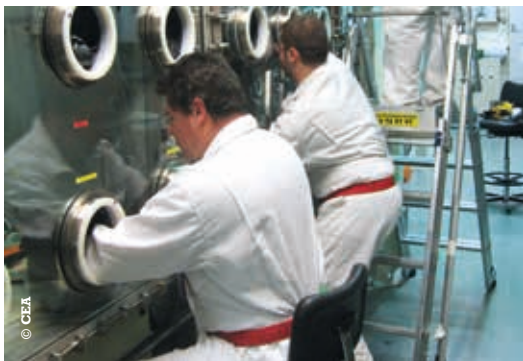
Travail sur le réacteur OHT (à l'intérieur des boîtes à gants) d'Atalante..
