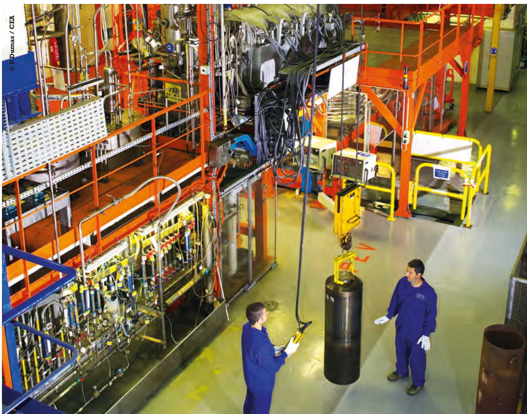
◀ Vue d'ensemble du prototype évolutif de vitrification équipé du creuset froid nucléarisé à Marcoule.
