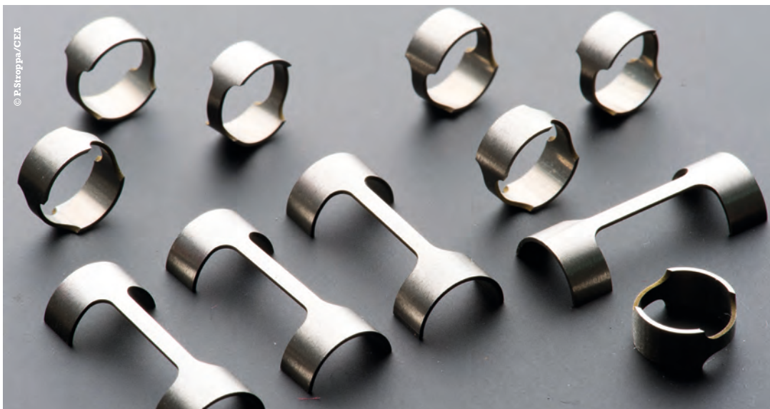
◀ Éprouvettes servant à l'évaluation du comportement mécanique d'un tube en acier.
