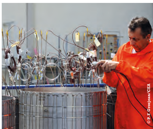
Montage d'une maquette de tuyauterie du circuit secondaire d'un RNR-Na pour des essais de systèmes de détection de fuite.
