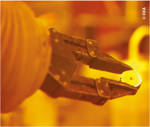
◀ Échantillon de combustible préparé en vue d'un examen métallographique en cellule blindée au Leca-Star.
