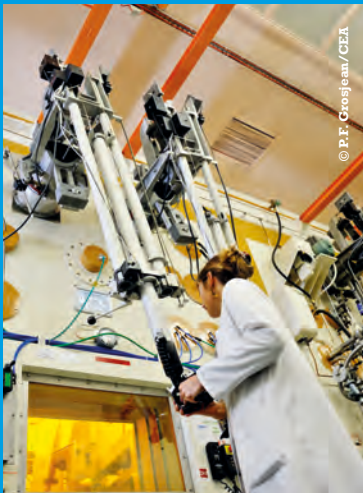
▲ Manipulation en téléopération dans les cellules chaudes de la ligne M du LECI.
