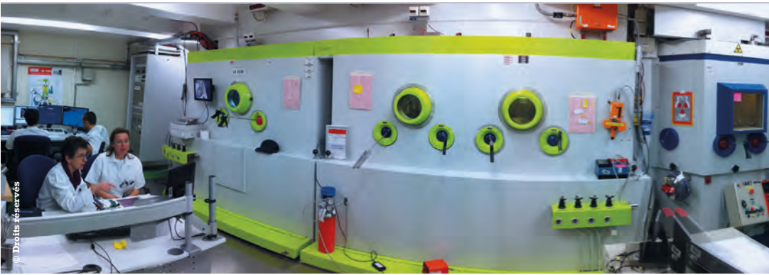
◀ Caissons blindés du Leca-Star qui abritent des équipements d'analyse microstructurale de combustibles irradiés.
