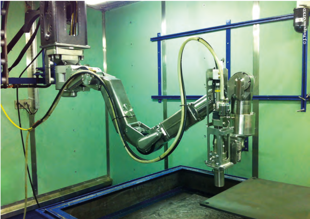
Bras esclave du système Maestro avec tête de découpe laser, permettant des opérations de découpe téléopérées.
