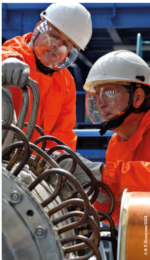
Montage d'une section d'essais destinée aux études de magnétohydrodynamique.
