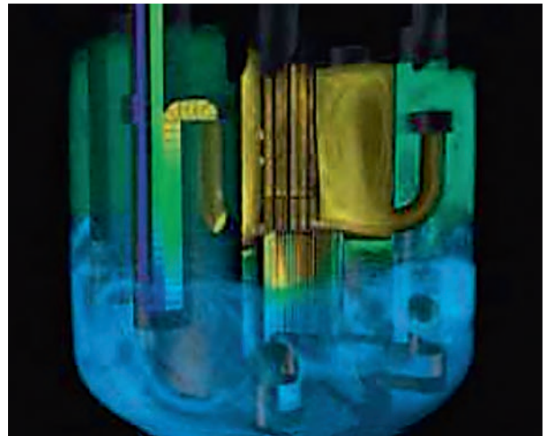
Fig. 34. Calcul multiéchelles de l'écoulement du sodium dans le réacteur à neutrons rapides ASTRID. Trois codes participent au calcul : le code système CATHARE pour l'écoulement sur l'ensemble du circuit primaire, le code CFD TrioCFD pour le calcul des recirculations de particules en amont et en aval du cœur et le code spécifique MC2 pour le calcul au sein du cœur d'ASTRID.
