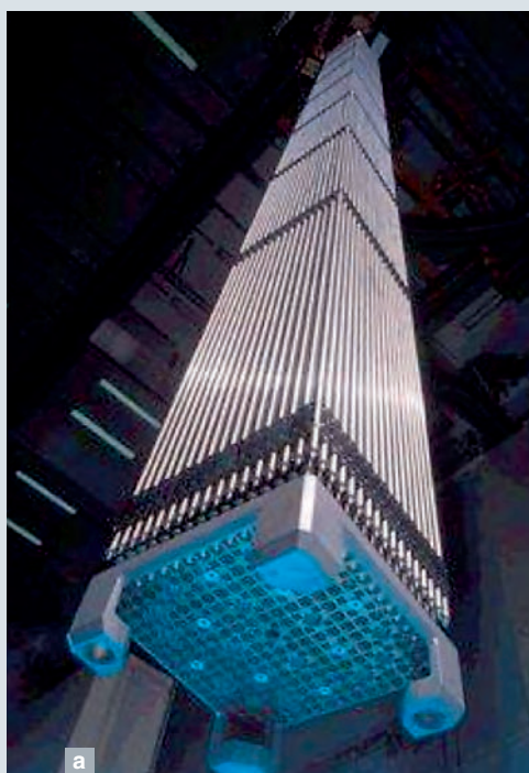
Fig. 165. Assemblage d'un réacteur à eau sous pression, crayons combustibles.
