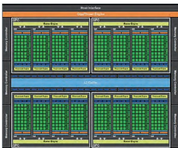
Fig. 19. Schéma bloc de l'architecture GPU CUDA de Nvidia (génération Fermi, 2010). Sur cet exemple, le GPU est constitué de 16 Streaming multi-processors contenant chacun 32 cœurs.
