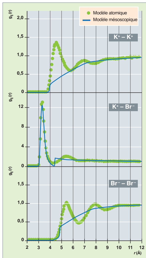
Fig. 128. Structure (fonctions de corrélations de paires) des solutions aqueuses de bromure de potassium. Les simulations de dynamique moléculaire où tous les atomes sont considérés explicitement sont en points verts. Le modèle mésoscopique est en bleu.
