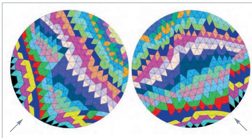
Fig. 155. Front des mailles traitées simultanément dans un maillage non structuré en 2D. Les flèches représentent la direction des vitesses des neutrons courante. Les mailles de la même couleur sont calculées en parallèle.
