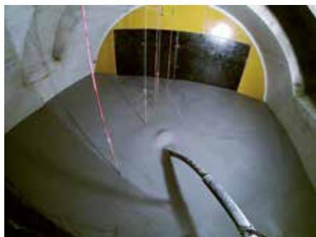
Remplissage avec du béton de la maquette visant à démontrer la faisabilité technologique des scellements des galeries de Cigéo.
