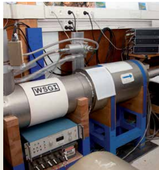
Le magnétomètre utilise l'effet Josephson.
