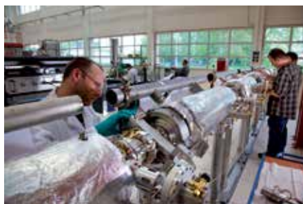
Montage du système de distribution d'hélium cryogénique pour l'accélérateur d'électrons XFEL.
