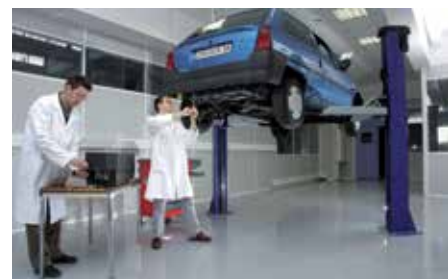
Instrumentation d'une voiture électrique pour mesure des performances énergétiques.
