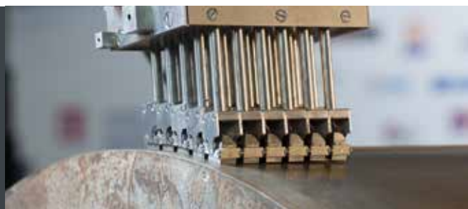
Inspection ultrasonore d'un rail.
