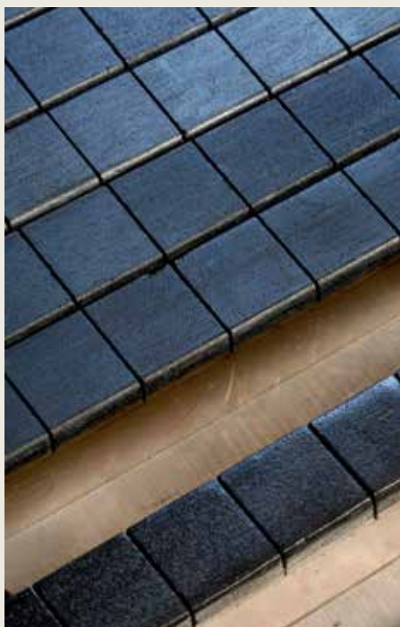
Limiteur plancher de Tore Supra, avec une liaison cuivre fibre de carbone.
