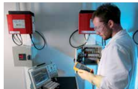
Le couplage panneaux-batteries et des onduleurs spécifiques, reliés au réseau EDF, sont étudiés pour l'habitat.
