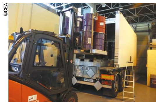
Ces fûts violets contiennent des déchets faiblement irradiants alpha-Pu qui sont évacués vers Cadarache.
