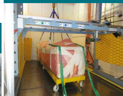
L'enceinte Gascogne 2 en place dans la salle de casse.
