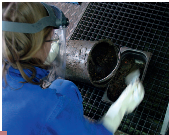
Prélèvement de boue des égouts urbains.
