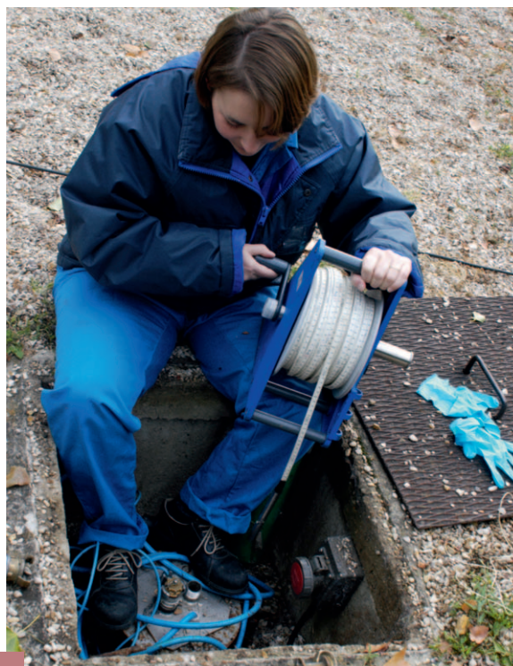
Mesure du niveau d'eau de la nappe phréatique perchée. © N. Marcelino/CEA
