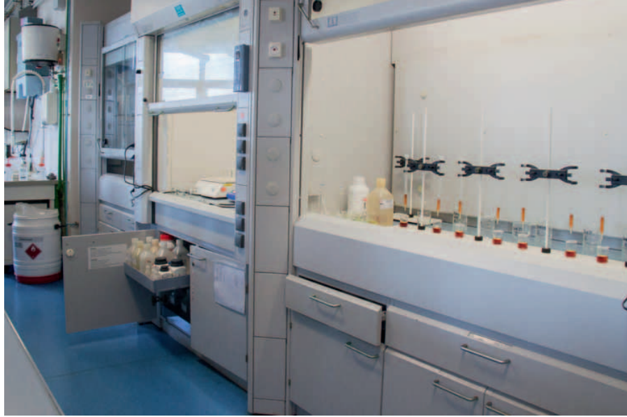
Séparation radiochimique des transuraniens sur colonnes de résines. © E. Guerre/CEA
