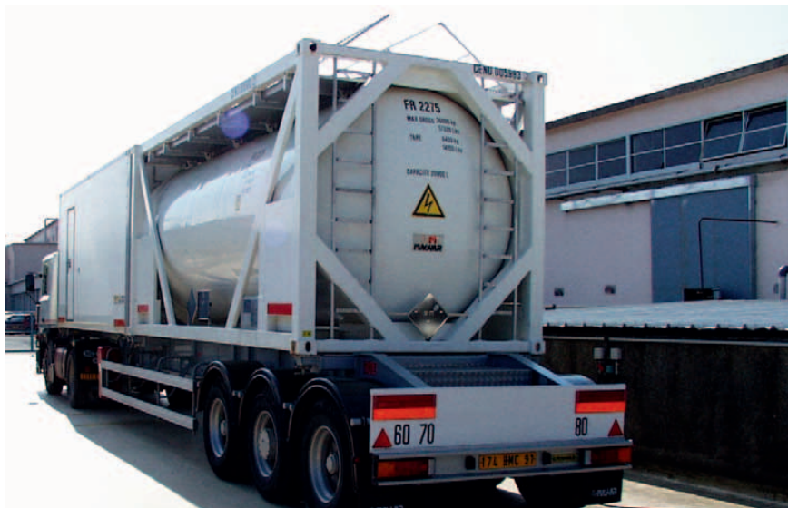
Transport d'effluents liquides radioactifs (citerne LR67). © CEA
