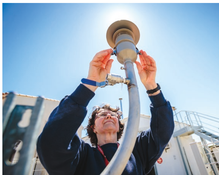
PRÉLÈVEMENT D'UN FILTRE PAPIER PIÈGEANT LES AÉROSOLS DE L'AIR
