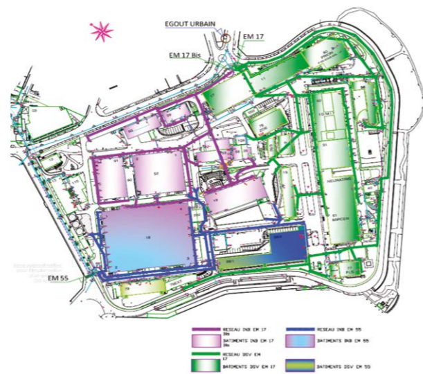
Figure n°2 : Schéma des émissaires de transfert à l'égout urbain des effluents liquides du site CEA de Fontenay-aux-Roses.
