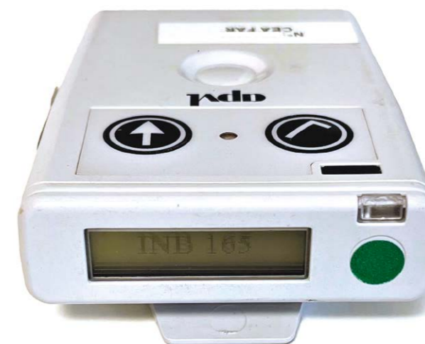
Le dosimètre actif (ou opérationnel) donne une information en temps réel lisible directement par le porteur.
