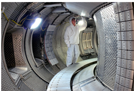
Intérieur du tokamak : sur la partie gauche se trouvent deux antennes de chauffage FCI sur les murs extérieurs. Les deux systèmes de chauffage permettent un chauffage du plasma par induction. © C.Roux/CEA
