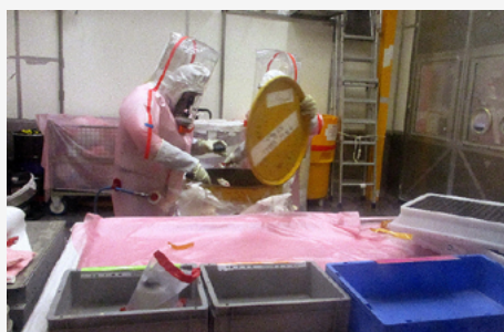
Début du tri et du reconditionnement des « fûts riches » provenant du parc d'entreposage de Cadarache. © CEA
