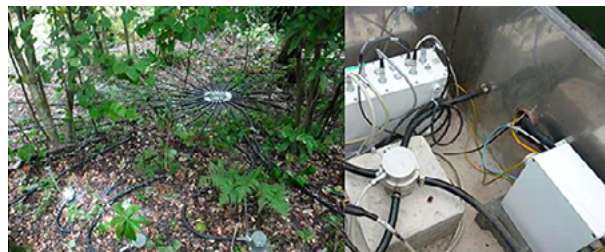
Illustration d'une station infrason et d'un microbaromètre utilisés pour la mesure des variations de pression atmosphérique. © CEA-DAM
