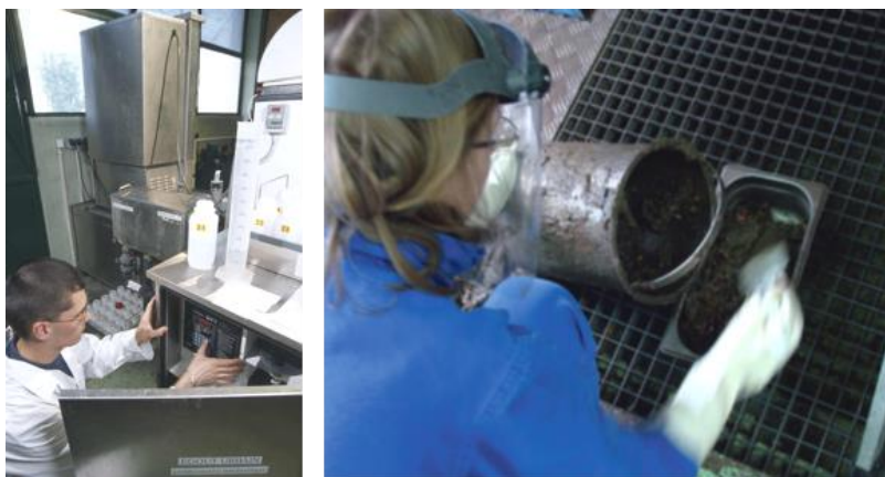
Surveillance en continu des émetteurs \beta\gamma de l'égout urbain et prélèvement de boues
