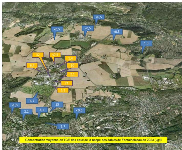
Figure 28 : Concentration en Trichloroéthylène (TCE) dans les eaux souterraines
