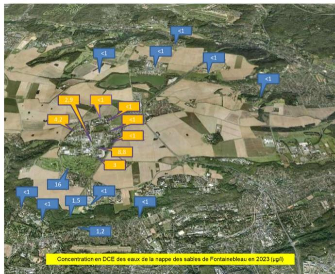
Figure 30 : Concentration en cis 1,2-dichloroéthylène (DCE) dans les eaux souterraines
