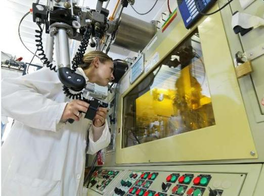
**Le laboratoire d'étude des combustibles irradiés (LECI-INB 50)** : il est dédié notamment à la caractérisation de matériaux non fissiles irradiés dans des réacteurs nucléaires de recherche ou de puissance, dispose de trois lignes d'enceintes blindées et d'un parc d'équipements scientifiques destiné à la recherche sur les matériaux pour le nucléaire.
