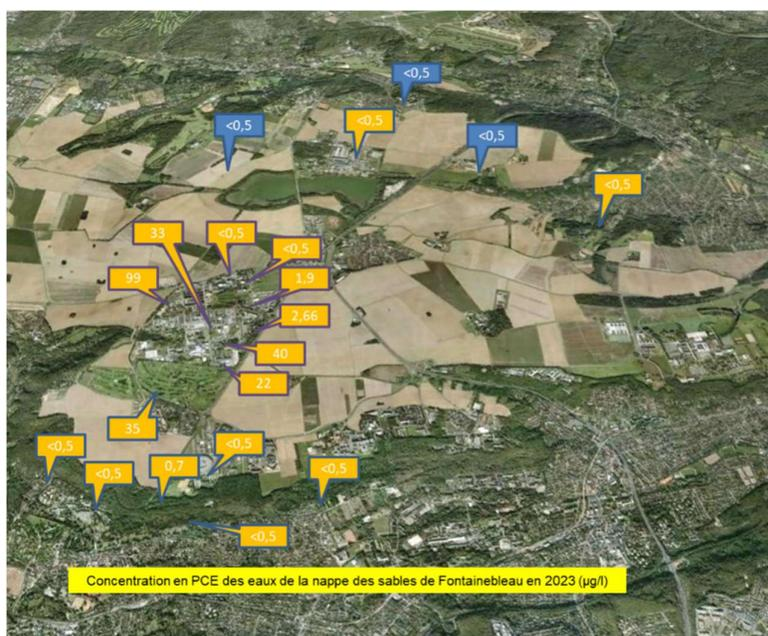
Figure 29 : Concentration en Tétrachloroéthylène (PCE) dans les eaux souterraines
