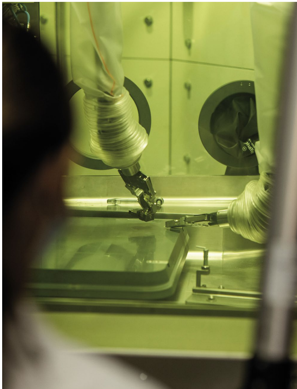
Manipulation en cellule blindée d'un échantillon destiné à être introduit dans un microscope double faisceau nucléarisé (MEB-FIB). Département pour les matériaux nucléaires. ©CEA/Y. Audic
