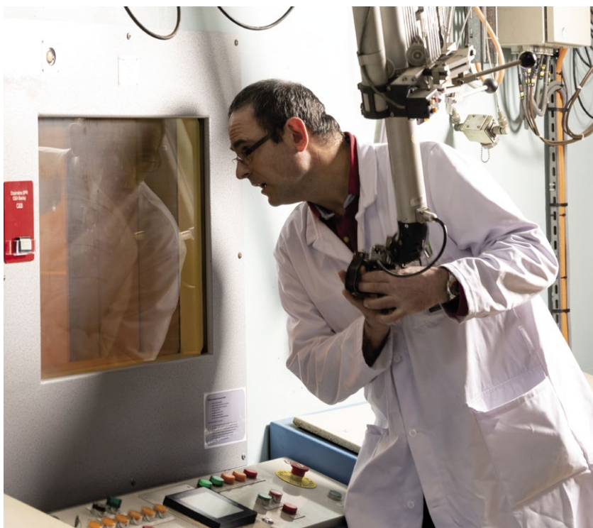
L'irradiateur Pagure comporte 6 sources de Cobalt 60 disposées au sein d'une salle de 25 m 2 . LABRA (INB 77). ©CEA/Ph. Stroppa
