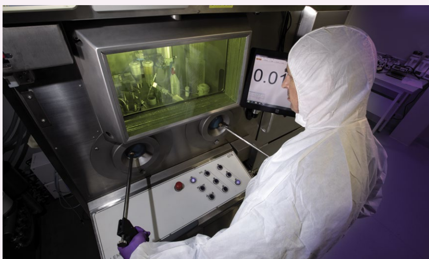
Boîte à pinces de laboratoire de production de la chaîne CaOr. Service hospitalier Frédéric-Joliot. ©CEA/F. Rhodes
