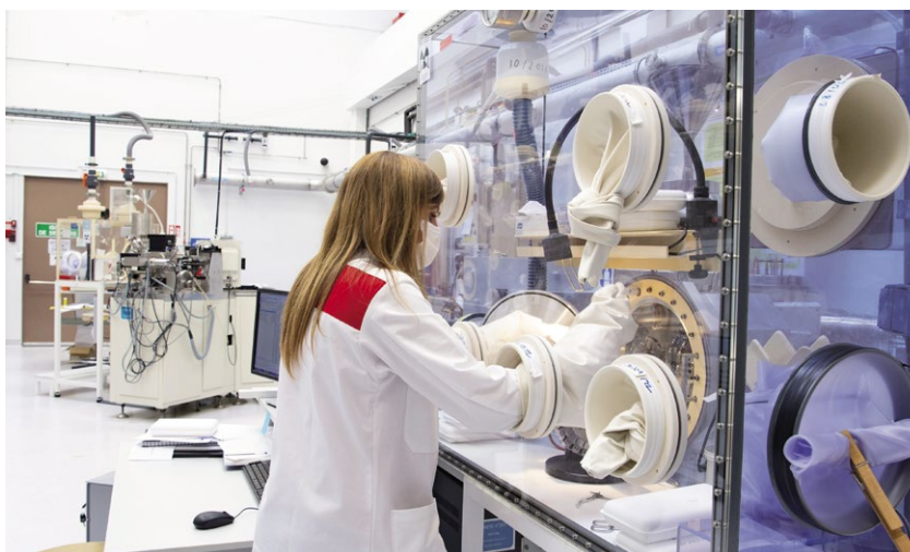
Spectromètre de masse à thermo-ionisation équipé d'une boîte à gants pour analyse de matériaux radioactifs. Département de physico-chimie. ©CEA/L. Godart
