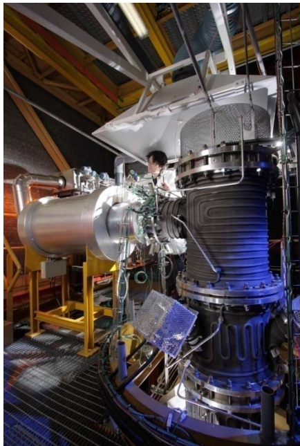
Exemples de la R&D du CEA sur les technologies biomasse : à gauche, installation PEGASE du centre CEA de Grenoble pour étudier les procédés de purification des gaz de synthèse (© P.Avavian/CEA). A droite, travaux sur la gazéification de la biomasse (© P.Dumas/CEA).
