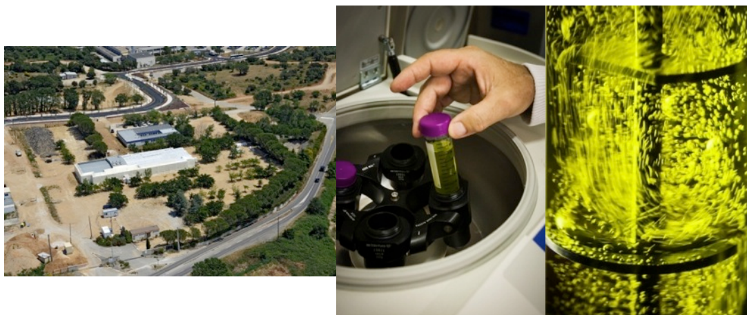
De gauche à droite : Vue aérienne du Parc régional d'activités économiques Marcel Boiteux © S. Le Couster/CEA - Expérience d'extraction de l'uranium en colonne pulsée de laboratoire. Préparation des échantillons avant analyse, par centrifugation (milieu). Emulsion dans le fût de la colonne pulsée (droite) © S. Le Couster/CEA
