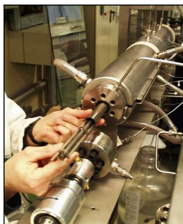
A gauche : prototype de traitement d'effluents, vue des internes du réacteur. A droite : pilote inactif de l'installation Delos de traitement des effluents organiques de haute activité, démarrée sur l'installation Atalante au CEA Marcoule fin 2014.
