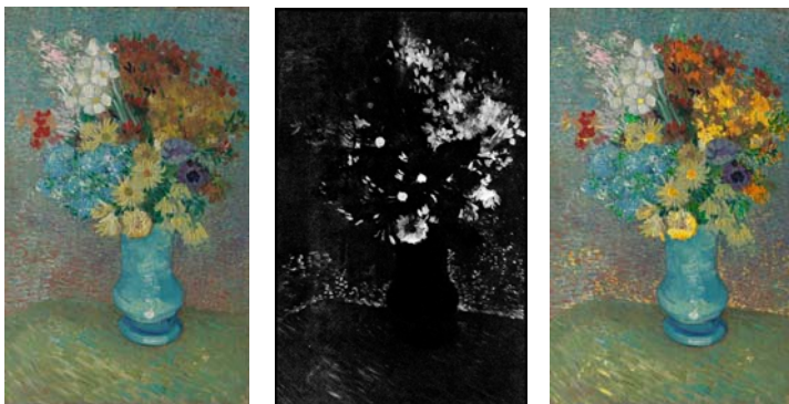
Image macro-XRF du pigment jaune de cadmium dans le tableau Flowers in a blue vase de Vincent van Gogh, 1889: photographie (Rijksmuseum Kröller-Müller, Otterlo, Pays-Bas), distribution du cadmium établie par macro-XRF, reconstruction virtuelle.
