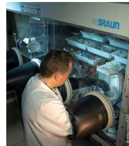
Boîte-à-gants dans laquelle est étudiée la réactivité de l'uranium.
