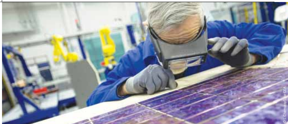
Vérification de modules photovoltaïques après encapsulation.
