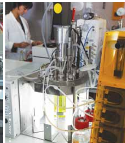
Cultures en photobioréacteur de la plate-forme biotechnologique HélioBiotec, pour étudier les mécanismes biologiques de micro-algues et cyanobactéries ayant la capacité de produire naturellement des molécules à forte teneur énergétique.
